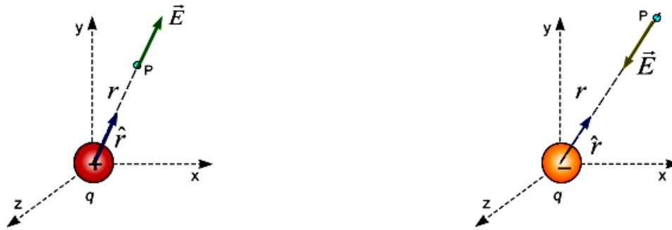
Fig. 2.3. Campo eléctrico generado por cargas puntuales: (a) positiva. (b) negativa
