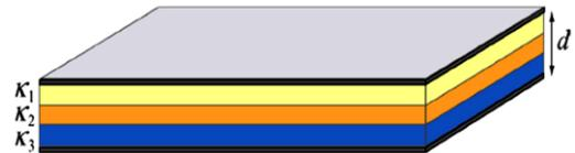
39. Un capacitor de placas planas paralelas de área A y espaciamiento d es llenado con tres dieléctricos como se muestra en la figura. Cada dieléctrico ocupa 1/3 del volumen. ¿Cuál es la capacitancia de este sistema?.
