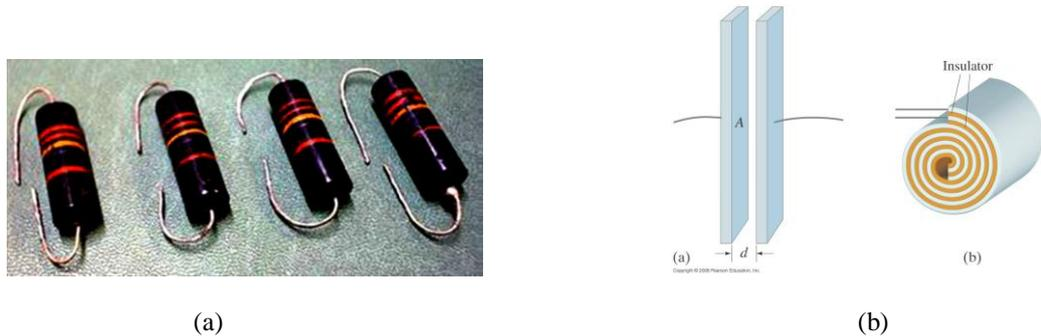
Figura 5.7 (a) capacitores de papel; (b) ensamblaje de capacitores de papel
