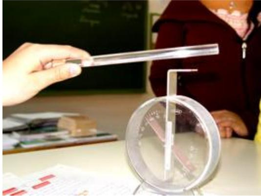
*Fig. 03. Varilla cargada acercándose al electroscopio*
